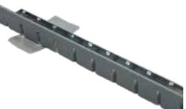
Kačírková a okrajová lišta pro střechy s přitěžující vrstvou kačírku a ukončení profilu dlažby, pro střechy a terasy s hlavní hydroizolační vrstvou PVC. Tuhost lišty je zajištěna ohybem 10 mm na koncích obou ramen. Spojovací díl pro snadné napojení další lišty. Na lišti je vysokofrekvenčně navařených 3–5 ks přízezů fólie mPVC 80×130 mm pro snadnou montáž.
