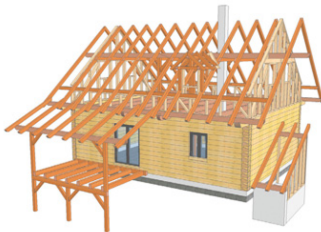
Konstrukční návrh v programu SEMA je zárukou stoprocentní přesnosti všech dřevěných prvků s důrazem na detail jednotlivých tesařských spojů.
