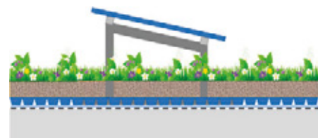
4) Princip biosolární střechy spočívá ve vyvýšené nosné konstrukci pro fotovoltaiku, která je plošně přitížena vegetačním souvrstvím. Zdroj: GreenVille
