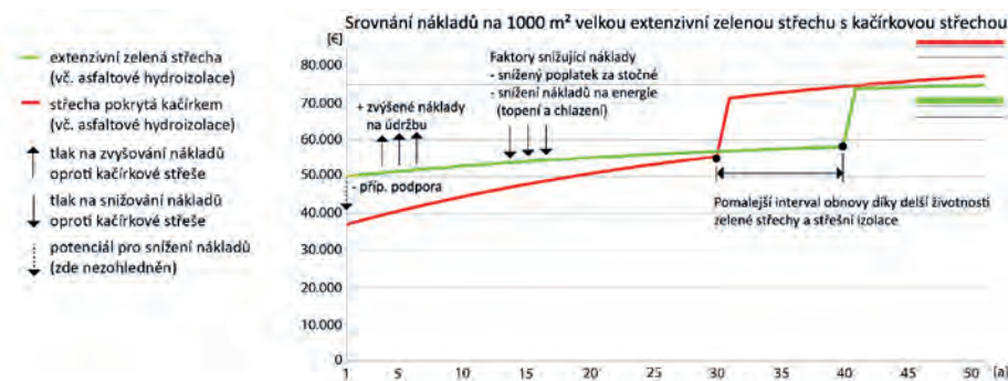
3) Srovnání životních cyklů extenzivní zelené střechy a střechy pokryté kačírkiem (pozn.: jedná se o propočty převzaté z Německa, tudíž jsou řešení oceněna draž než na českém trhu, kde by se ceny pohybovaly zhruba na polovinu). Zdroj: Pfoser, et al., 2013.
